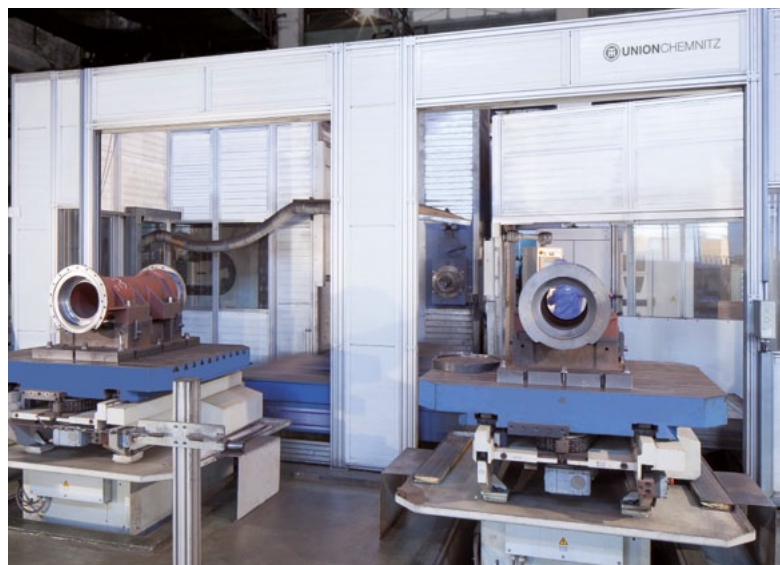
Konstrukcja maszyny z podwójnym stołem
