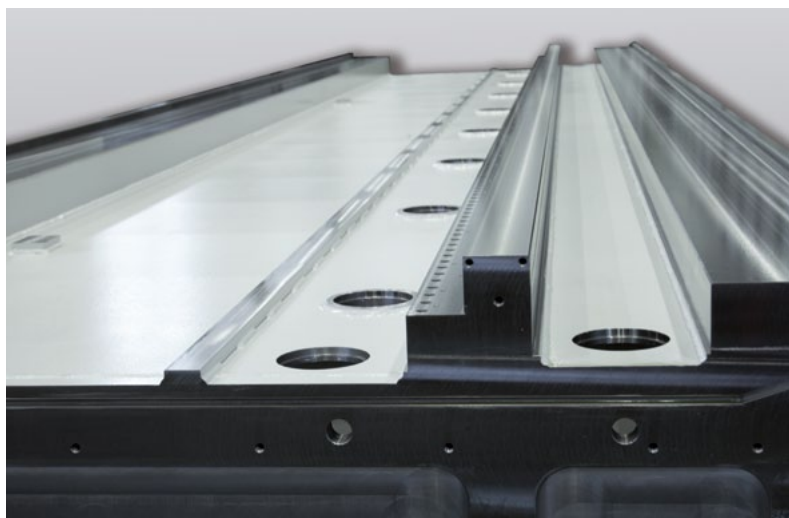
Solidne, precyzyjnie obrabione łożo maszyny
