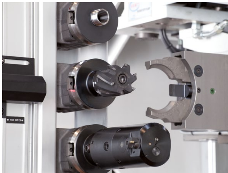
Automatyczny podajnik narzędzi z magazynu
