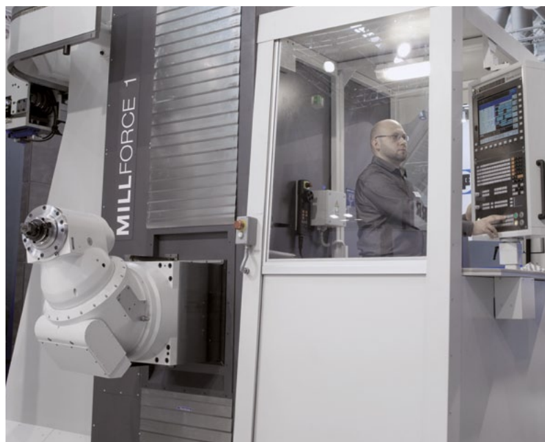
Zabudowany podest dla obsługi, przejezdny wraz kolumną
