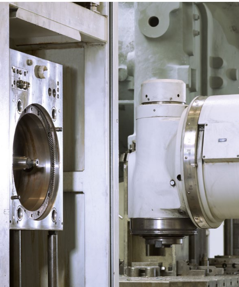
Stacja „pick-up” do automatycznego dokowania wyposażenia dodatkowego
