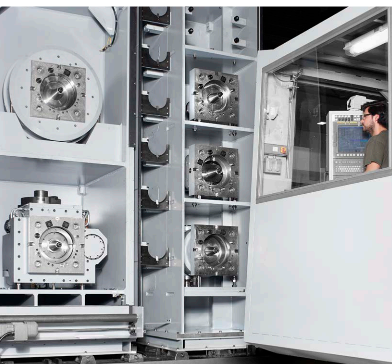
Stacja Pick-up dla wielu głowic frezarskich i dodatkowe miejsca do odkładania narzędzi specjalnych
