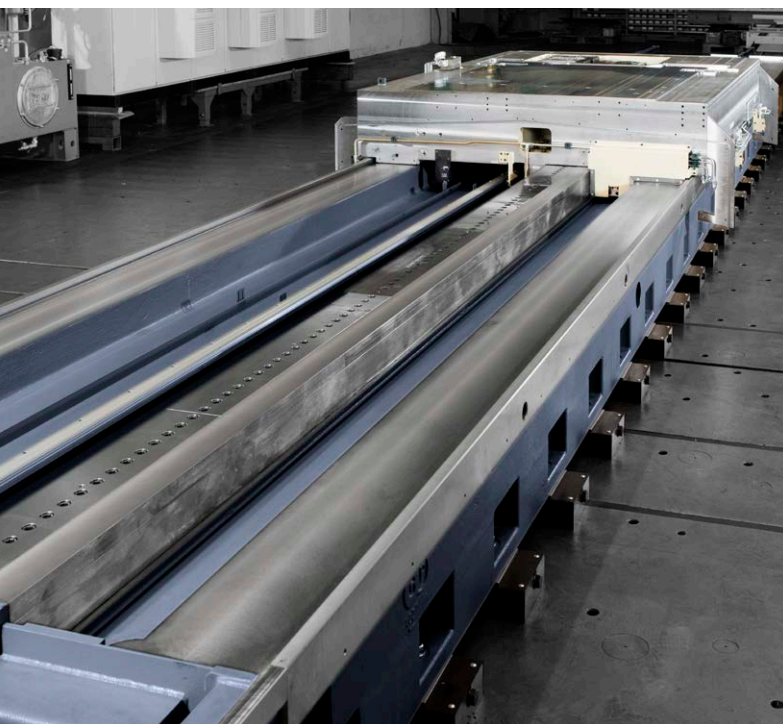
Hydrostatyczne prowadnice mocnego łoża maszyny
