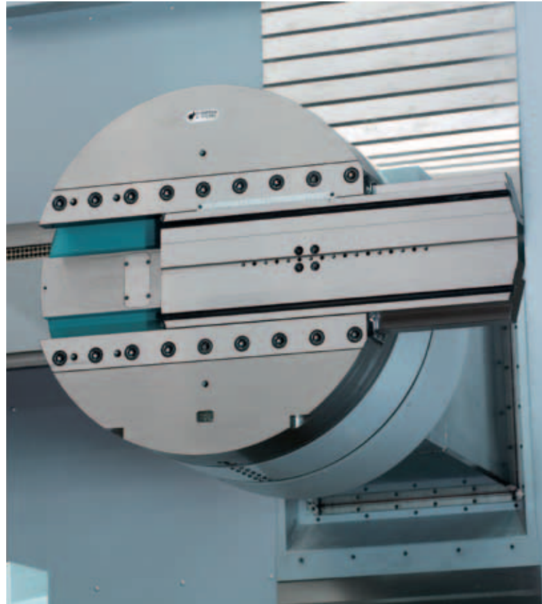
Belka nośna RAM z zamontowanym suportem planującym
