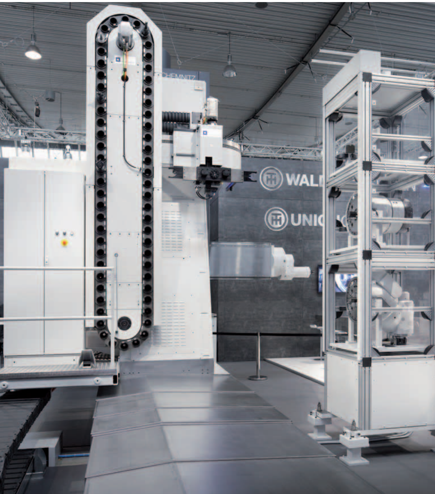
Frezarka uniwersalna z przejezdną kolumną do obróbki pojedynczych detali jak również do produkcji mało- i średnioseryjnej.
