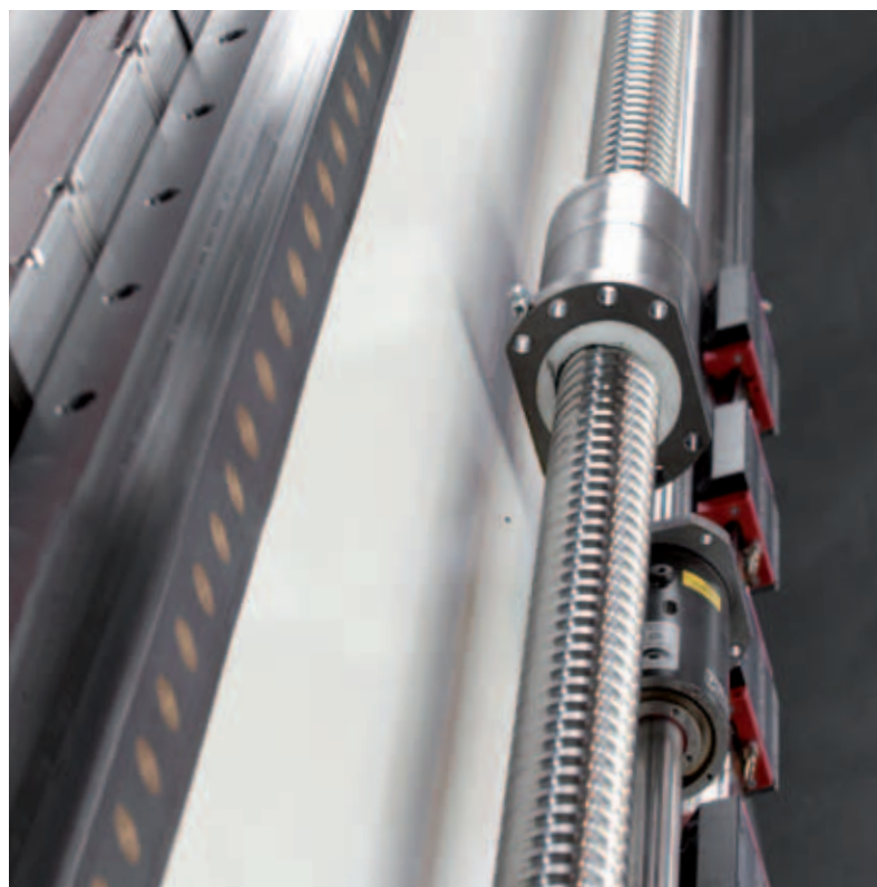
Prowadnice kompaktowe, kulowo-toczne śruby napędowe i bezpośredni system pomiarowy
