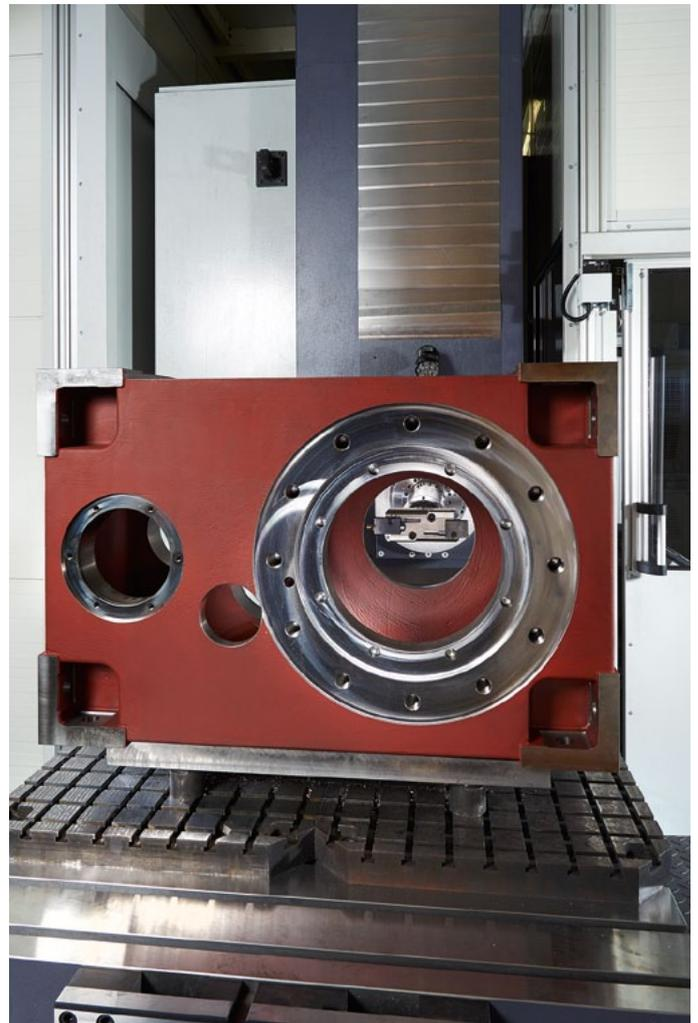
Hochgenaue Bearbeitung eines Getriebegehäuses
