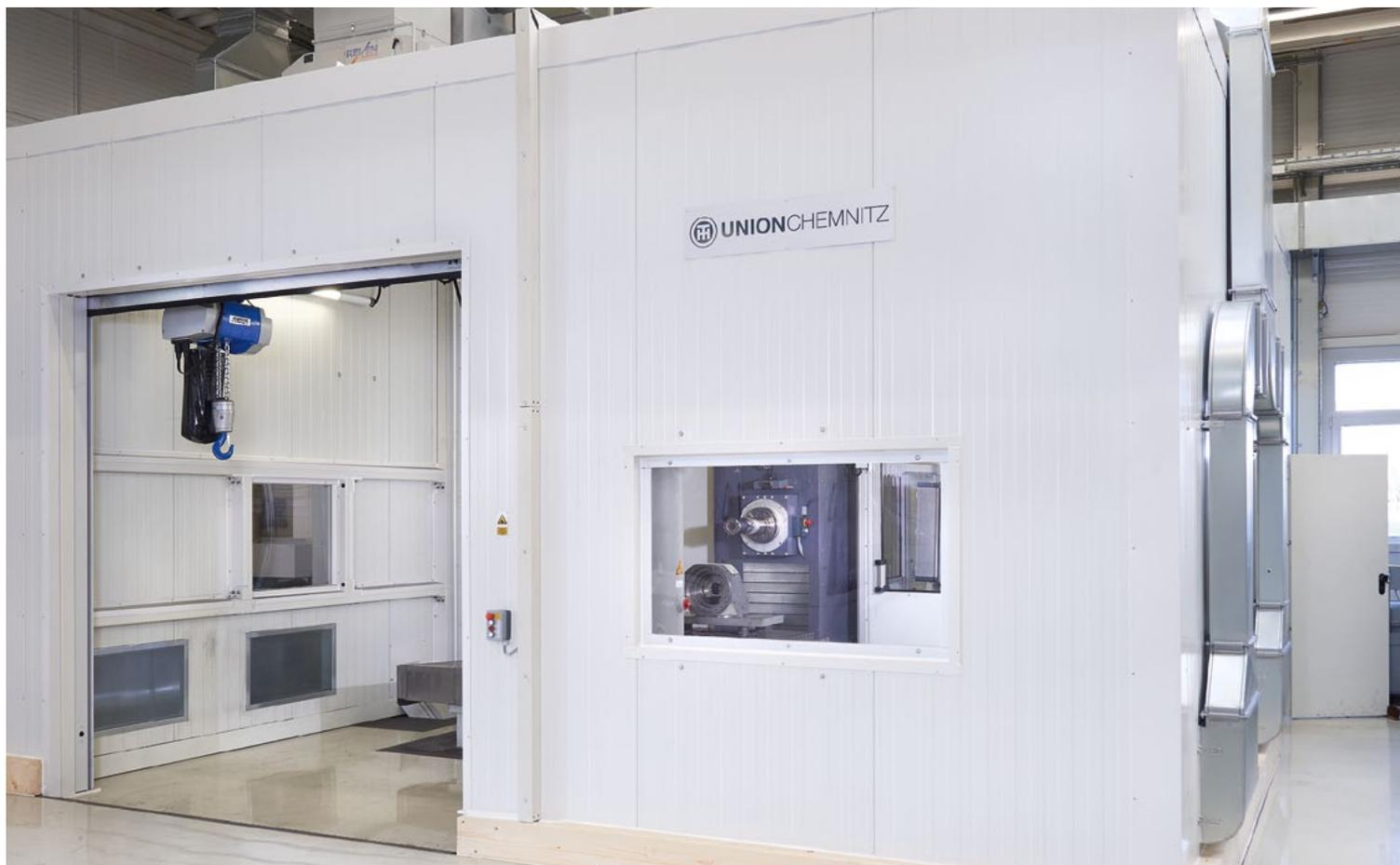
Genauigkeitsbohrwerk mit klimatisiertem Arbeitsraum
