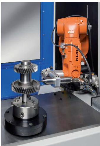
2 Kombinacja przegubowego ramienia robota i systemu wahadłowej głowicy z narzędziem do gratowania, względnie frezowania faz, zwiększa elastyczność zastosowań urządzenia.
